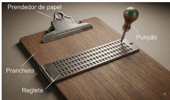
Figura 13.9 – Prancheta, reglete e punção para escrita braille
