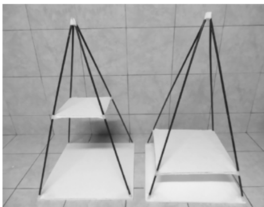
Figura 8.8 – Placas menores colocadas entre o topo da pirâmide e a base
